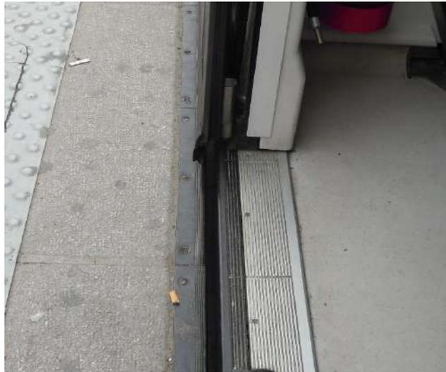
Figura 41 - Incarrozzamento a raso.
