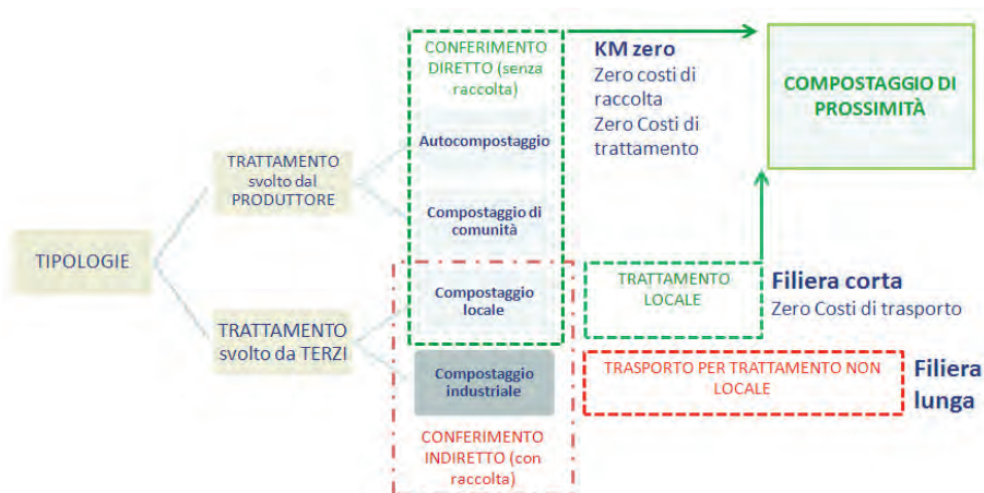
Figura 2. Compostaggio a piccola scala dei rifiuti organici e possibili tipologie di trattamento
