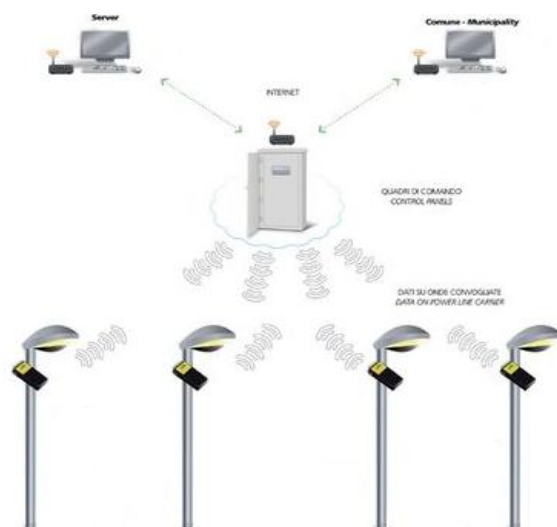
Figura 6.27: Sistema di telecontrollo e gestione energetica
